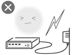
雷雨天气请将设备电源及所有连线拆除，以免遭雷击破坏
